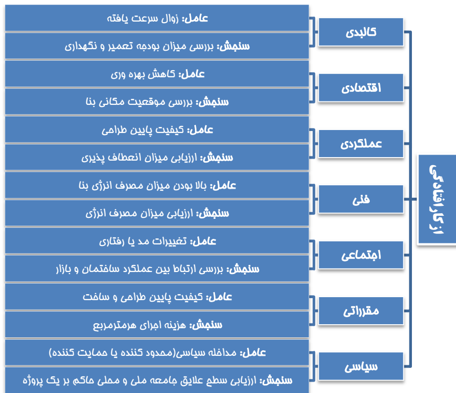
شکل (۳): انواع از کار افتادگی ها، عامل و معیار سنجش آنها، ماخذ: نگارندگان (بر گرفته از لانگستون ۲۰۰۷ و ۲۰۱۴)
